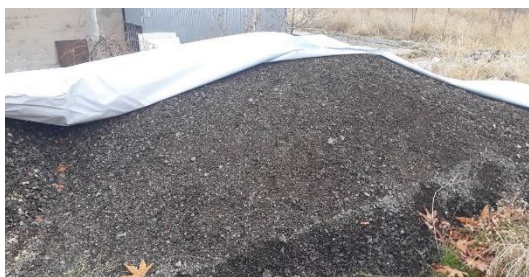
دپوی تراشه های آسفالتی برداشت شده از یکی از معابر مشهد
